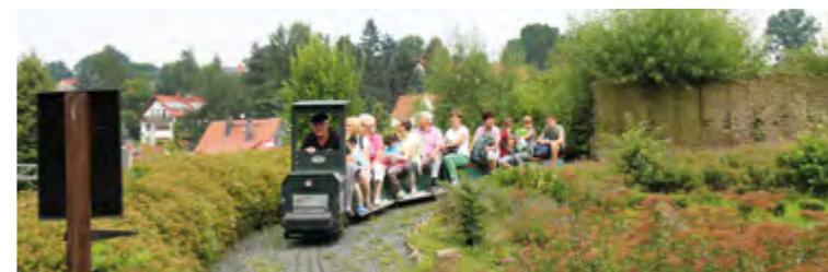
Die Miniatur-Dampflok „Gerlinde“ ist als echte Dampflok die große Sensation. Ein Niederdruckkessel wird mit Steinkohle befeuert und funktioniert in allen Details wie ihre großen Schwestern. Diese kleine Dampflok kann 6 Personen befördern und kommt in der Regel nur bei Parkevents zum Einsatz.
